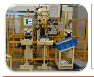
Outra máquina avaliada pelo Cerest contempla mais proteções como: grades, cortina de luz, comando bimanual, instalação berço para solda da peça e de instalação bi-manual;
