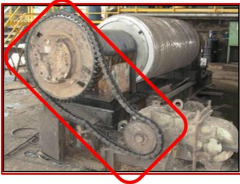
Figura 2 - Correia de transmissão de força sem proteção
